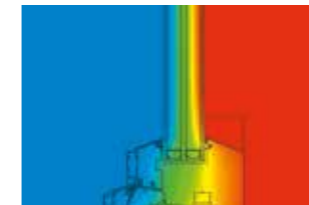
Optimaler Isothermenlauf bei richtiger Dämmung
